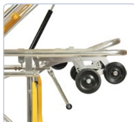
Адаптивные загрузочные колеса. Возможен наезд на любое ПУ.
